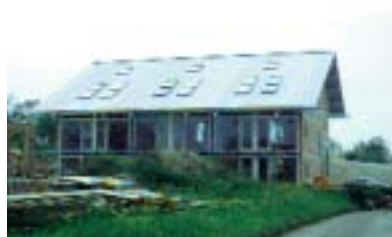
Abb. 7: Zu große Fensterflächen können zu Überhitzungsproblemen im Sommer führen.
